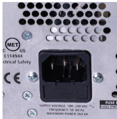
Módulo de entrada de energía
