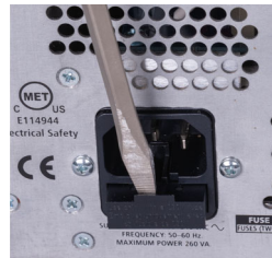
Extracción de portador de fusibles
