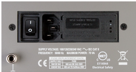
Figure 2. Détail du module d’entrée d’alimentation sur le panneau arrière de l’instrument APx. Le commutateur d’alimentation secteur est situé à gauche.
