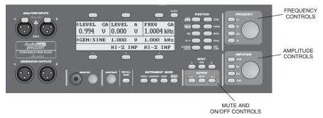
Figure 4-9. Generator Controls
